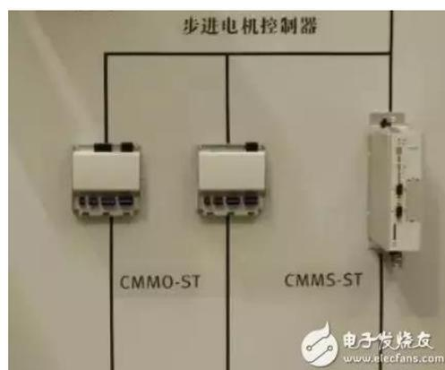
步进电机控制器：它是一种能够发出均匀脉冲信号的电子产品，它发出的信号进入步进电机驱动器后，会由驱动器转换成步进电机所需要的强电流信号，带动步进电机运转。步进电机控制器能够准确的控制步进电机转过每一个角度。驱动器所接收的是脉冲信号，每收到一个脉冲，驱动器会给电机一个脉冲使电机转过一个固定的角度，就因为
