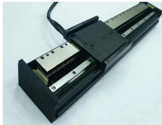
目前，模具加工用的高速加工中心多数还是采用伺服电机和滚珠丝杠来驱动直线坐标轴，但部分加工中心已采用直线电机，由于这种直线驱动免去了将回转运动转换为直线运动的传动元件，从而可显著提高轴的动力性能、移动速度和加工精度。
