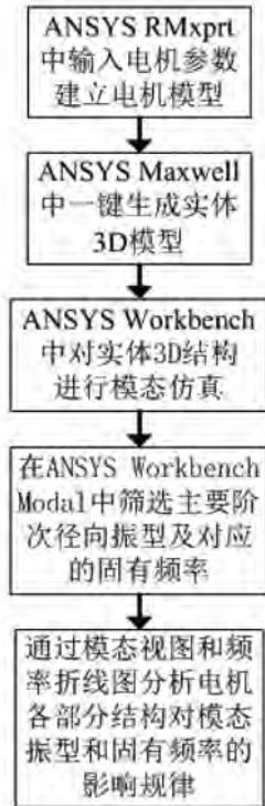
图 2 基于 ANSYS 平台的多物理场耦合分析流程图
