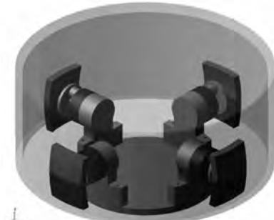
图 2 控制电机偏转运动的结构
