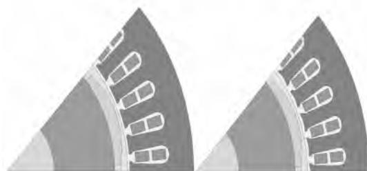
图2 1/8圆的定子齿冠偏心前和偏心后的对比
