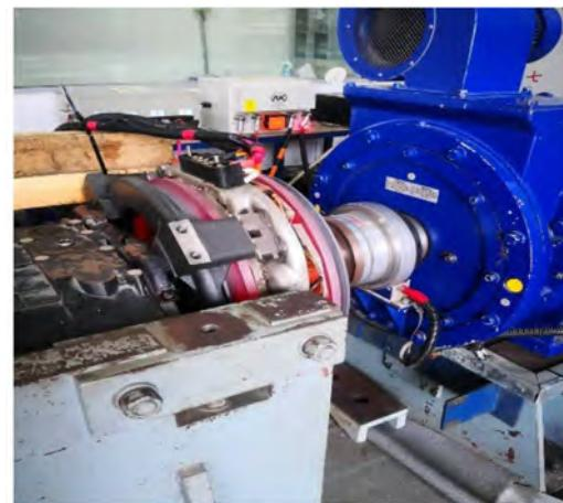
图 11 试验中温度达到 589°C 的转子盘
