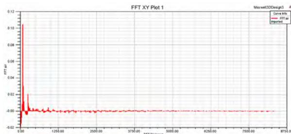
图 4 直线电机气隙磁场频谱
