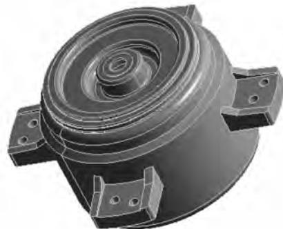
图 1 塑封电机定子端盖结构
