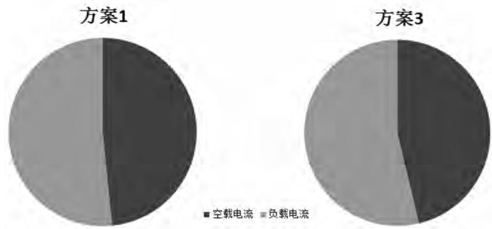
B、各部分损耗对比:方案1采用高牌号470材料时,铁损明显降低,电机可变损耗与不变损耗趋于相当;方案3采用高牌号470材料时,铁损虽有所降低,但铜耗也随之增多。
