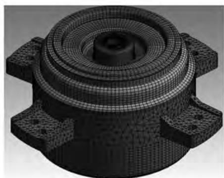
图 2 电机网格模型
