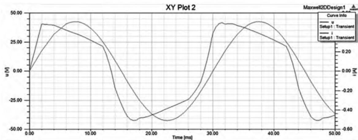
图 9 反电动势与电流波形
