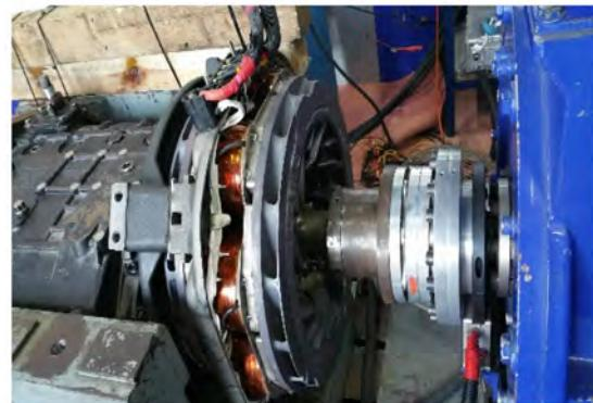
图 10 电涡流缓速器台架实验
