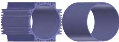
图 7 机壳的实际图与等效图
