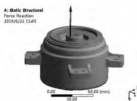
图 11 拉拔力云图
