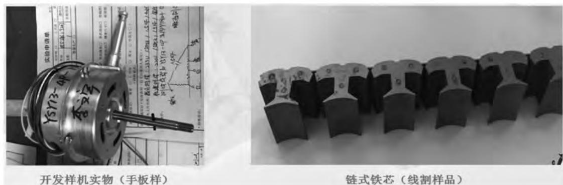
图 11 风扇新结构样机及链式铁芯
